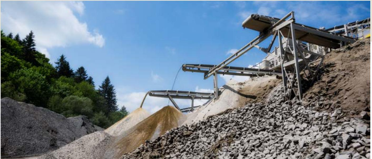
Las bandas textiles ConVeyBelts están diseñadas desde dentro hacia fuera para soportar el intenso transporte diario de toneladas de carbón, áridos, madera, mineral y otros materiales. Tejidos especialmente desarrollados para esta aplicación se prensan entre
